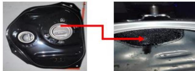
Gambar 6. Temuan *reject* masuk cat pada fuel tank
