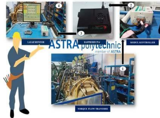
Gambar 12. Layout pengujian performa transmisi HD785-7 di PT X
