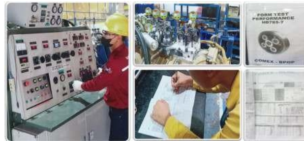
Gambar 6. Kondisi pengujian performa transmisi dengan Maruma MH-125D
