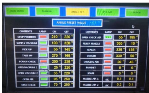
Gambar 1. Posisi Sudut Angle Set dalam Menentukan ON/OFF Keluaran
