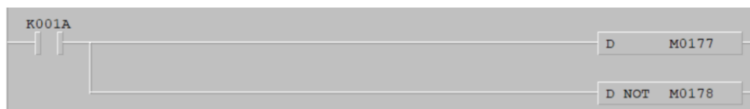
Gambar 5. Rangkaian PLC Positive dan Negative Transition
