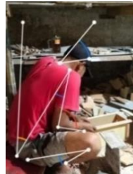
Gambar 3. Pengukuran REBA proses perakitan
