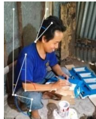
Gambar 4. Pengukuran REBA proses pengecatan
