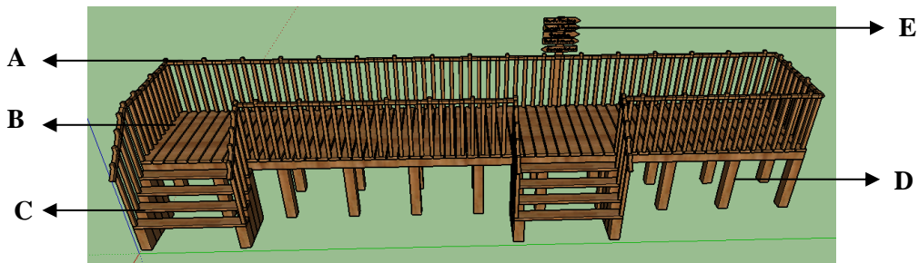
Gambar 2. Desain Boardwalk Tampak Depan
